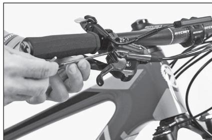
Ajuste de la distancia de la palanca del freno del manillar
