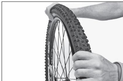
Presionar con ambas manos la cubierta y comprobar que la cámara de aire no esté atascada debajo de la goma
