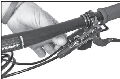
1. Regular el tensado con el tornillo a través del cual el cable entra en la palanca de cambio.
