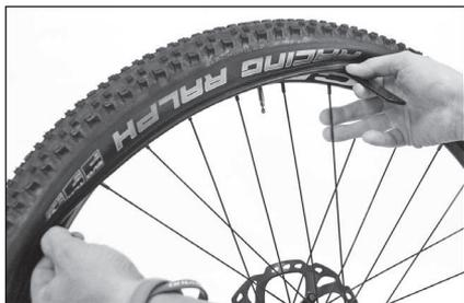
Colocar la palanca de montaje y levantar el costado de la goma haciendo palanca en la llanta
