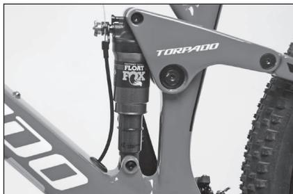
El desplazamiento del anillo 0 en el amortiguador indica la carrera empleada
