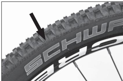
Indicación de la presión máxima de inflado en el costado de la cubierta
