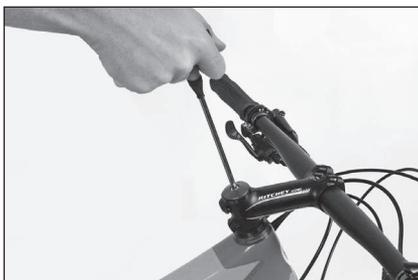
Luego de haber aflojado los tornillo de bloqueo laterales regular el juego de la dirección con el tornillo de ajuste empotrado en la parte de arriba
