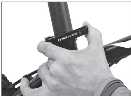
Para configurar la altura de sentado es necesario desatornillar los tornillos del cierre de la tija del sillín, o abrir el bloqueo rápido
