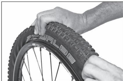
Empujar la cubierta hacia el centro de la llanta
