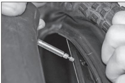
Introducir la válvula en el orificio de la llanta
