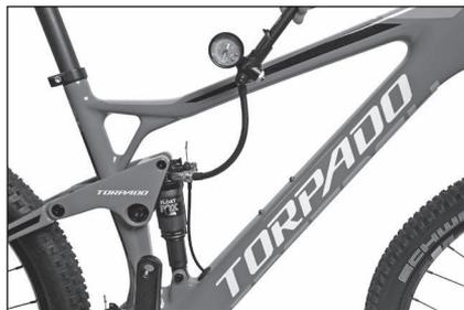
En el caso de amortiguadores neumáticos será necesario regular la presión del aire
