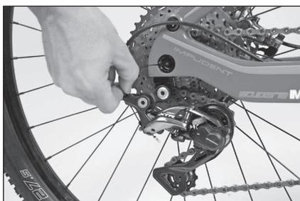
1. Ajustar la tensión del cable con el tornillo de ajuste.
