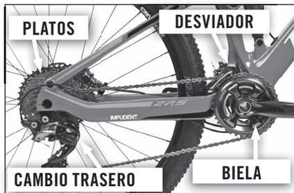
Sistema de transmisión con indicación de la biela, platos, desviador, cambio trasero
