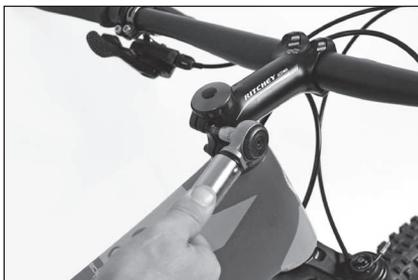
Ajustar nuevamente los tornillo laterales de la potencia del manillar con una llave de torsión
