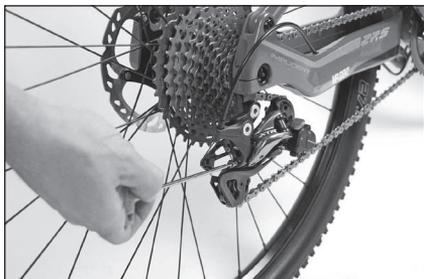
7. Observando la posición del balancín respecto a los platos, entre la polea y el piñón más grande debe ser posible hacer pasar por lo menos uno o dos eslabones. Si no se produce de este modo regular esta distancia actuando en el tornillo del cambio trasero, colocado en el lado delantero de la puntera.
