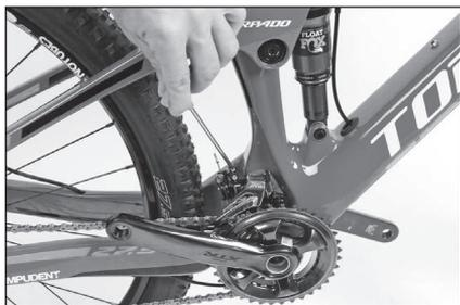
2. Utilizar los tornillos de regulación de los "finales de carrera" para limitar el recorrido del desviador.
