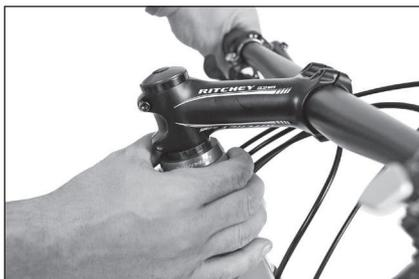
Para comprobar el juego de la dirección, accionar el freno delantero, empujar hacia adelante y hacia atrás la Mtb Torpado, apoyar una mano en la cazoleta
