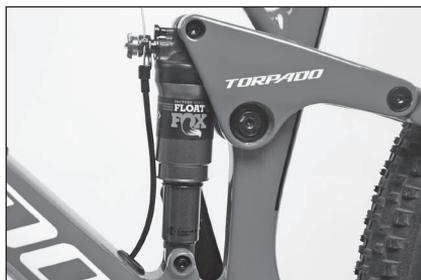
Anillo a 0 colocado arriba del amortiguador
