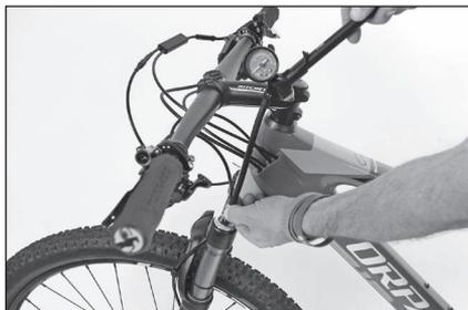
Ajustes de la constante del muelle con una bomba para amortiguadores
