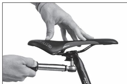
Atornillar ambos tornillos progresivamente y en el sentido alternado, no supere nunca el par de bloqueo máximo permitido
