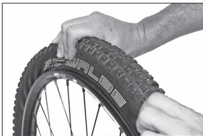
Empujar hacia el centro de la llanta la cubierta sin la cámara de aire
