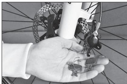
Sustituir las pastillas de freno desgastadas
